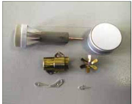
schiedenen Messingrohren zusammen gelötet. Verschliffen wurde er auf einer Drehmaschine. Nach dem Schleifen wurden die ganzen Stangen nach Plan angeleitet und verschliffen. Die Verspannung besteht zum Teil aus 0,3 und 0,5 mm Edelstahl draht sowie verdrehten Kupfer-
