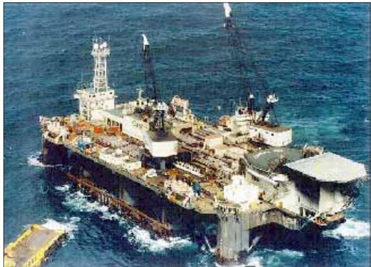
*Als Beispiel wird das Verlegefahrzeug CASTORO SEI gezeigt. Es ist 151,80 m lang, 70,50 m breit, 29,80 m hoch, max. 15,50 m tief, hat eine Wasserverdrängung von 41.500 BRT und eine Besatzungsstärke von rund 300 Personen.*
